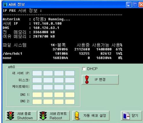
16. DHCP 혹은 IP와 DNS(DNS의 경우 사용하는 트렁크 회사의 DNS를 이용하시기 바랍니다.)를 입력한 후 IP 변경 버튼을 누르시면 됩니다. 이후 서버 리부트를 해주시면 적용됩니다. 단, 서버 리부트 시에는 통화중인 모든 통화가 끊기므로 주의하시기 바랍니다.
